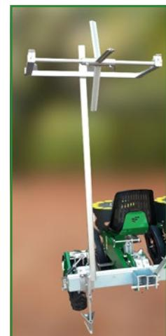
Supporto per la bobina della manichetta per irrigazione con vomere interrante
